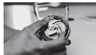
2. Na hřídel uložte nůž ve správném směru.
