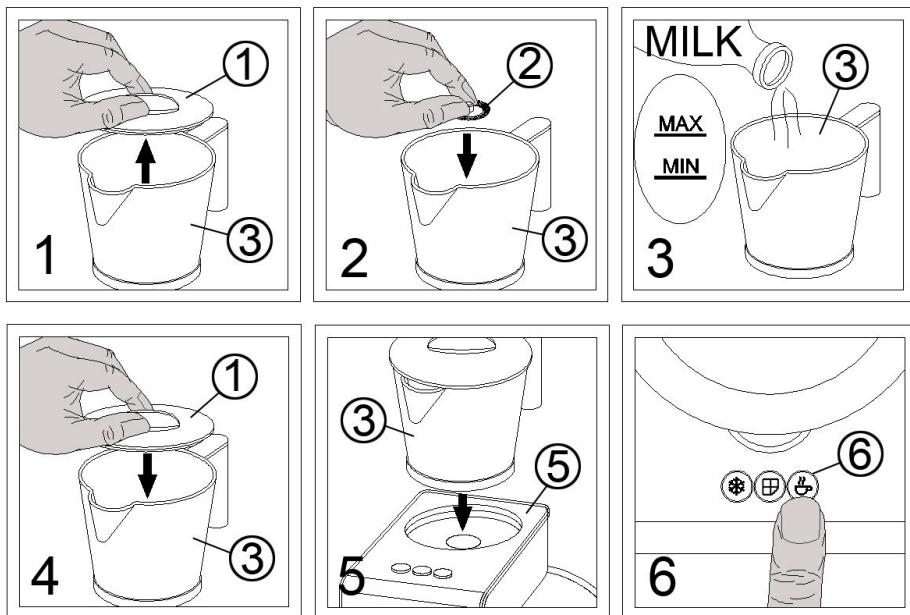
**Obr. 1:** Odstraňte poklici (1) z míchací nádoby (3)
