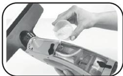
3. Do meracej nádoby (4) nalejte čistiaci koncentrát a doplňte čistou vodou. Objem nádoby (4) je 80 ml. Prístroj držte v horizontálnej polohe a obsah nádoby (4) prelejte do nádržky na čistú vodu (16). Nádobku uzatvorte uzáverom nádržky čistej vody (15).
