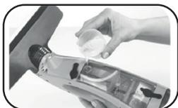
3. Do odměřovací nádoby (4) nalijte čistící koncentrát a doplňte čistou vodou. Objem nádoby (4) je 80 ml. Přístroj držte v horizontální poloze a obsah nádoby (4) přelije do nádržky na čistou vodu (16). Nádobku uzavřete uzávěrem nádržky čisté vody (15).
