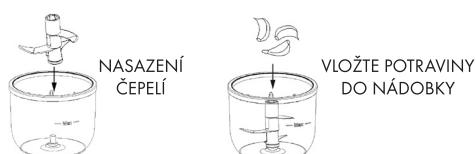
**VAROVÁNÍ: NEJDRÍVE VLOŽTE ČEPELE DO NÁDOBKY A POTOM VLOŽTE POTRAVINY, JINAK NEBUDE MOŽNÉ UMÍSTIT ČEPELE NA SVÉ MÍSTO.**
