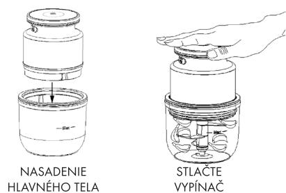
3. Nasadte kryt a hlavné telo na nádobku. Uistite sa, že magnety na mixovacej nádobe sedí vo vnútri štrbin na hlavnom tele. V tomto prípade je aktívovaný indukčný mechanizmus. Modrý indikátor sa zablíka. Potom môžete sťačením vypínača produkt zapnúť. Ked' je v dzbáne príliš mnoho potravín, čepeľ sa môže zaseknúť. Vytiahnite nadmerné množstvo potravín. Nainštalujte hlavné telo na nádobku a znova stisnite spínač, aby sa vaše potraviny rozmixovali.
