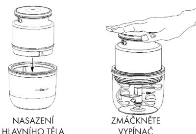
3. Nasadte kryt a hlavní tělo na nádobku. Ujistěte se, že magnety na mixovací nádobě sedí uvnitř štěrbin na hlavním těle. V tomto případě je aktivován indukční mechanismus. Modrý indikátor 5x zabliká. Poté můžete stisknutím vypínače produkt zapnout. Když je ve džbánu příliš mnoho potravin, čepel se může zaseknout. Vyjměte nadmerné množství potravin. Nainstalujte hlavní tělo na nádobku a znova stiskněte spínač, aby se vaše potraviny rozmixovaly.
